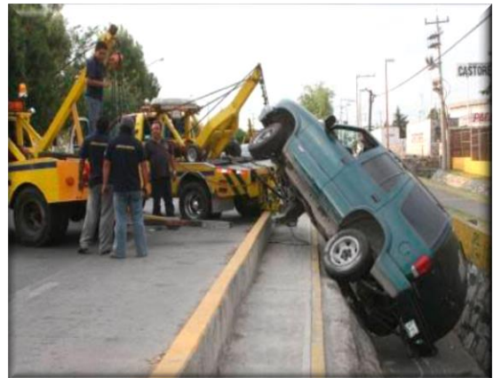
Figura 4. Levantamientos de vehículos grandes y pequeños en grúas de arrastres
