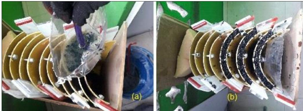
Fuente: elaboración propia. (a) Vaciado mezcla, (b) Proceso de fraguado
