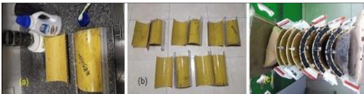
Fuente: elaboración propia. (a) Formaleta con desmoldante jabón, (b) formaleta con desmoldante cinta transparente, (c) Vaciado de mezcla
