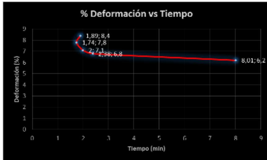
Fuente: elaboración propia. La deformación tiende a estabilizarse a través del tiempo, a medida que incrementa el peso.
