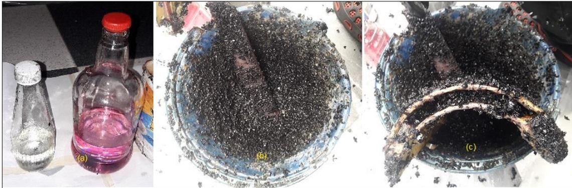
Fuente: elaboración propia. (a) Resina poliéster, Mek (b) Mezcla (c) Vaciado
