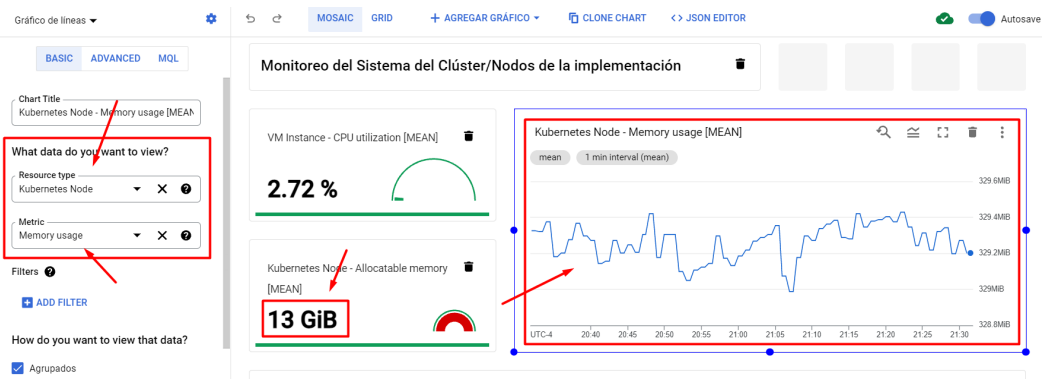
Figura 7.11: Configuración de gráfica del Dashboard para monitorear la memoria en uso promedio por todos los Nodos.
