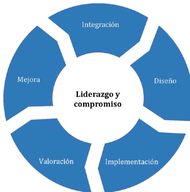
Figura 6: Marco de referencia de la gestión de riesgos, según la norma ISO 31000 Fuente: UNE-ISO 31000:2018.
