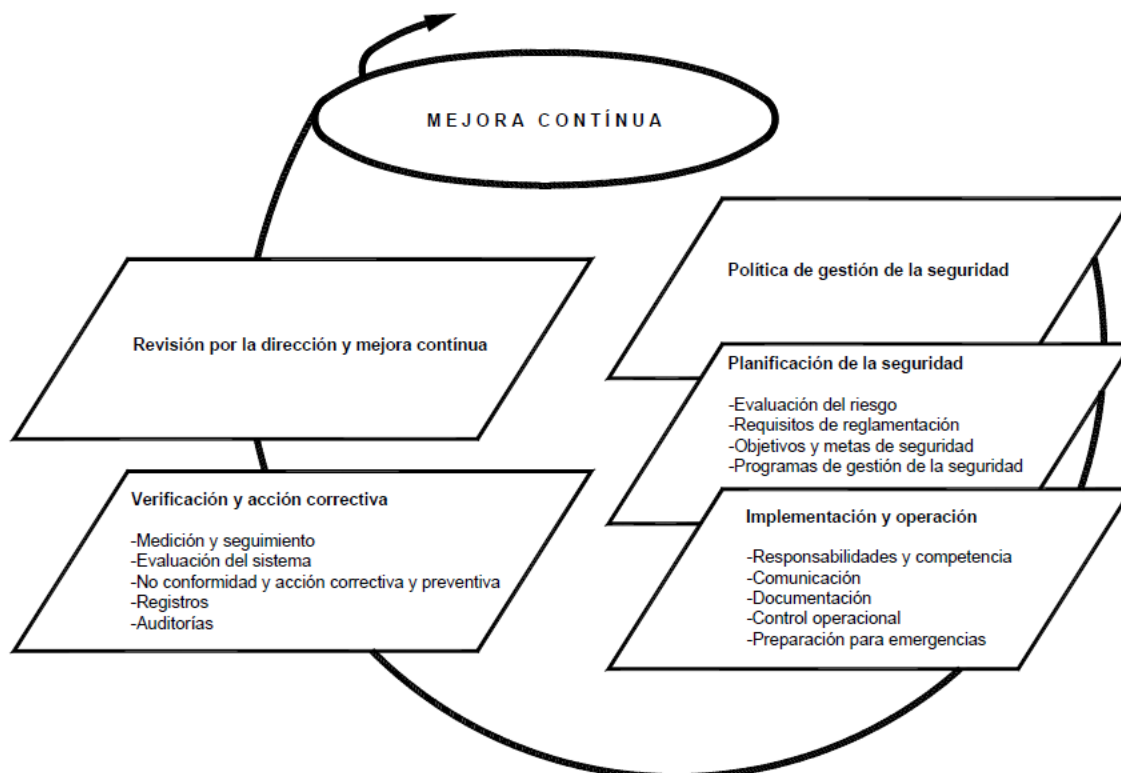
Figura 10. Elementos del sistema de gestión de seguridad
