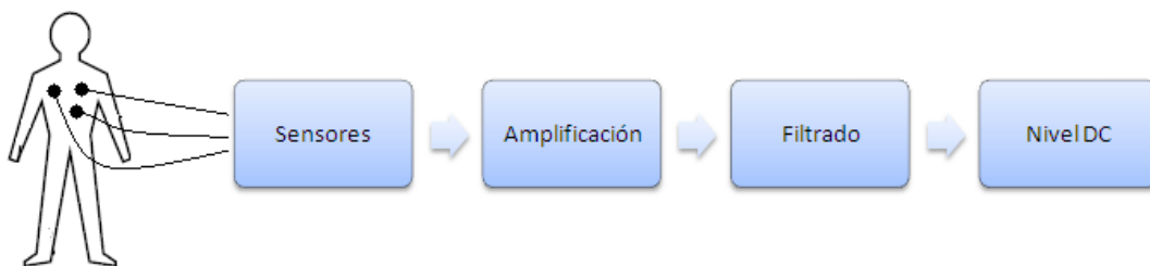
Figura 9. Diagrama de bloques Acondicionamiento de la Señal ECG
