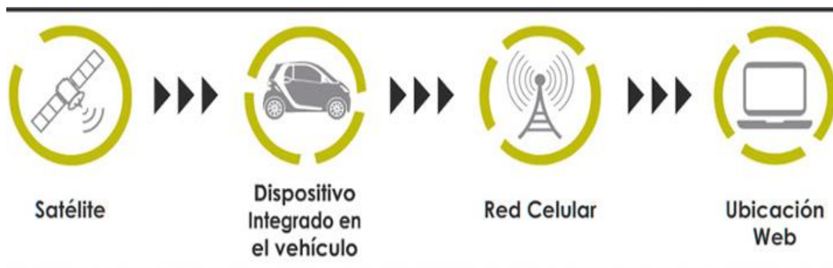
Grafica N° 1. Funcionalidad Dispositivo AVL Dual Fuente: Fuente: Imágenes Google
