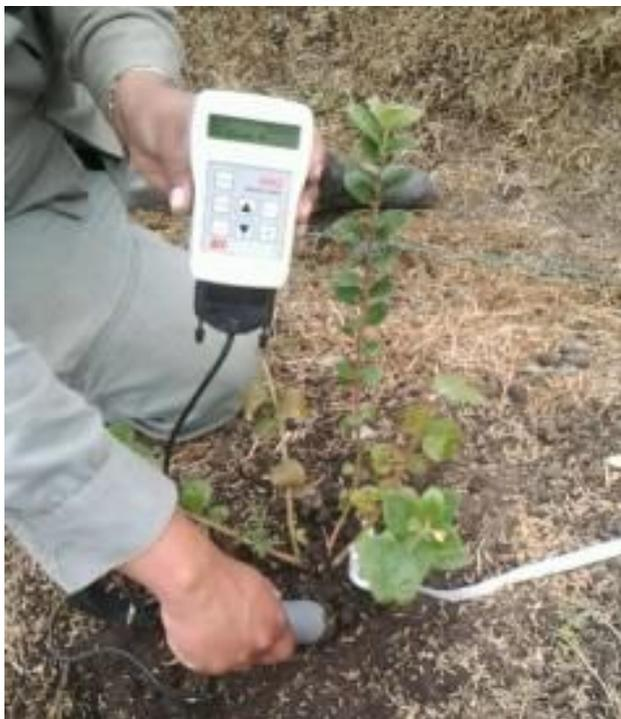
**Figura 6. Medición del volumen de agua disponible en el suelo utilizando un thetaprobet. Foto: Caballero 2014.**
