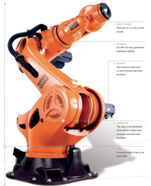
(a) Robot manipulador KUKA de 6 ejes (cortesía de KUKA Robots IBÉRICA, S.A.)
