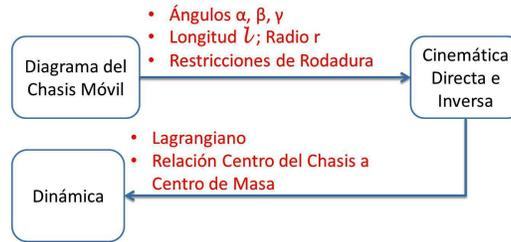
Figura 3.14: Diagrama de Flujo - Modelos del Chasis Móvil
