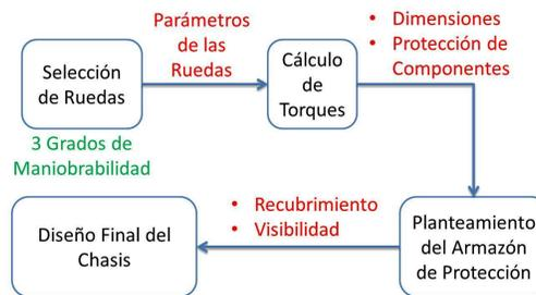
Figura 3.7: Diagrama de Flujo - Diseño del Chasis Móvil
