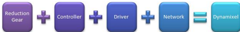
Figura 53 Estructura Dynamixel AX-12 a
