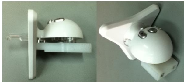
Figura 4.1: Modificación del gripper del Novint Falcon .
