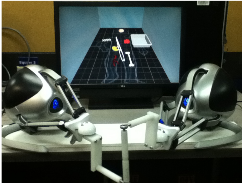
Figura 4.2: Sistema háptico de 5 GDL implementado a los dos Novint Falcon .
