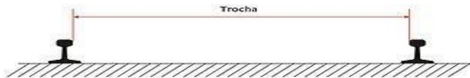
*Imagen 10. Superestructura ancho de trocha. (Informe De Seguimiento De Proyectos De Infraestructura.)*
