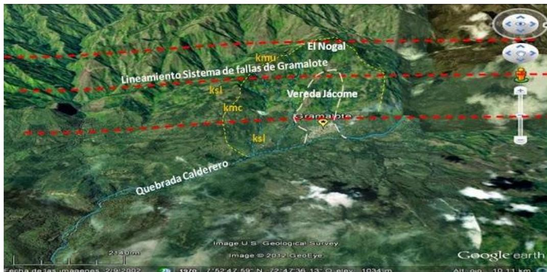
**Figura 9.** Trazos del sistema de fallas estructurales de Gramalote y área des movimiento en masa. Fuente. ( Pedroza Rojas, 2015)
