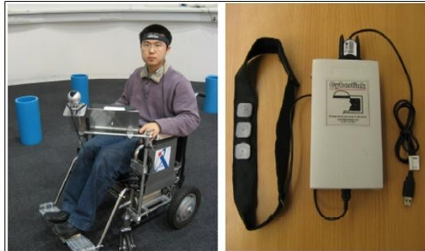
Figura 1: Persona en silla de ruedas inteligente (izquierda); Cyberlink™ con la cinta para la cabeza (a la derecha)
