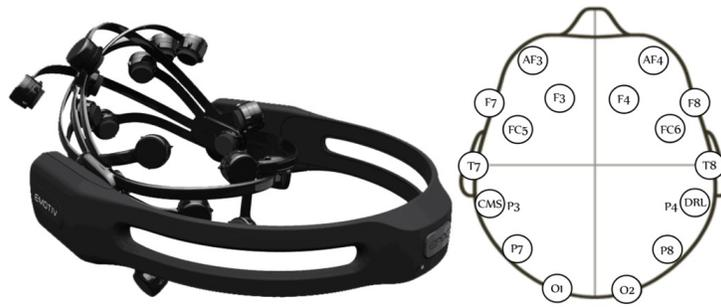
Figura 17: (a) EEG Emotiv EPOC (b) Posición de los sensores en la configuración 10-20
