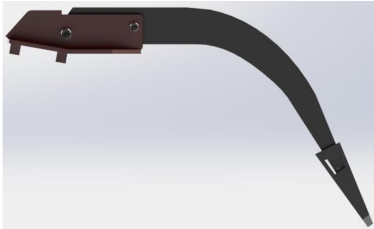
Ilustración 37. Vista lateral arado tipo cincel, realizada en SolidWorks®.
