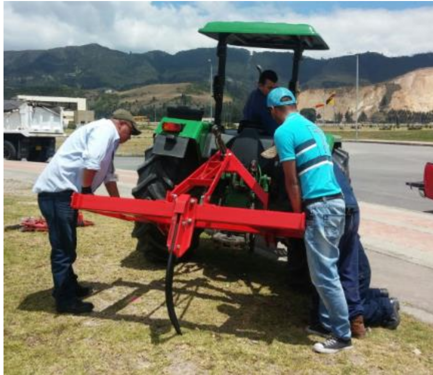
Ilustración 68. Anclaje arado tipo cincel al tractor.
