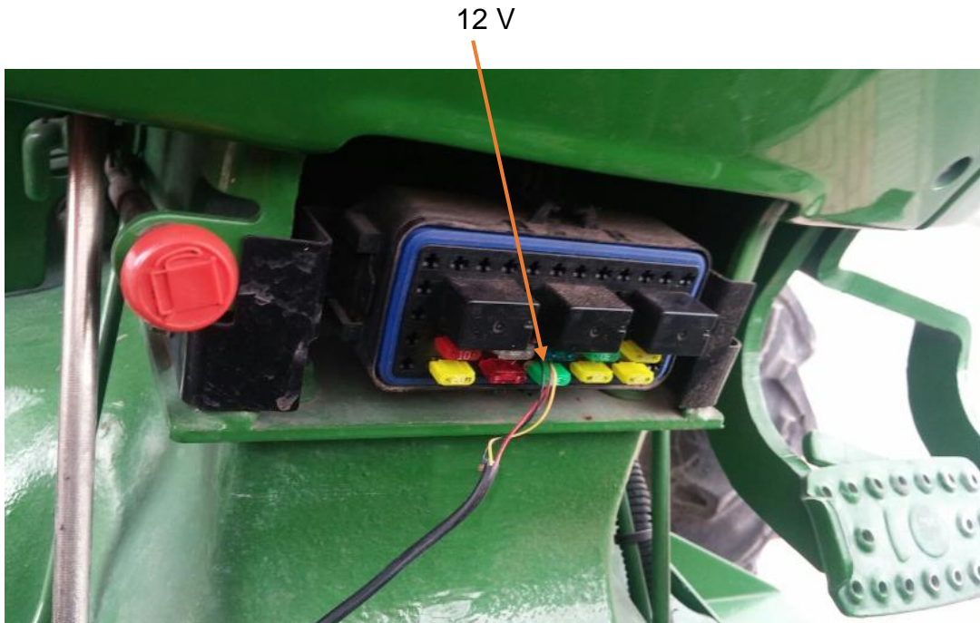
Ilustración 22. Alimentación de 12V tomada de la tensión del tractor para alimentar el circuito electrónico.
