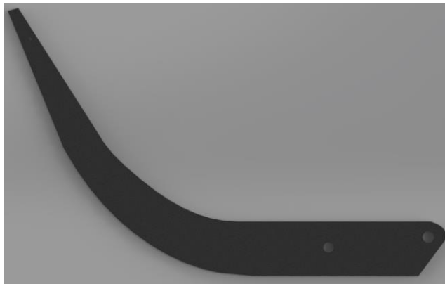
Ilustración 40. Vista frontal cincel, realizada en SolidWorks®.
