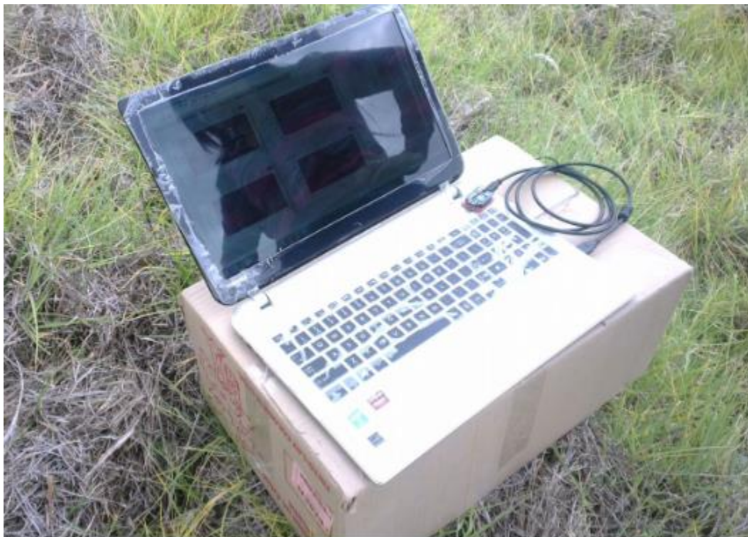
Ilustración 69. Computador con módulo XBee encargado de la recepción de datos.
