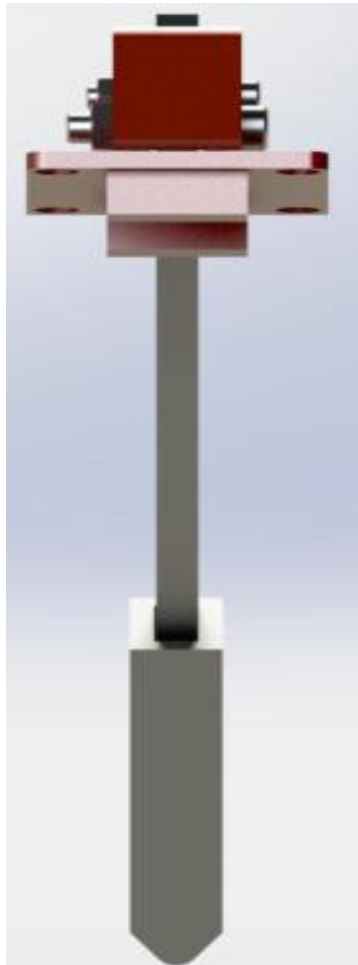
Ilustración 38. Vista frontal arado tipo cincel, realizada en SolidWorks®.
