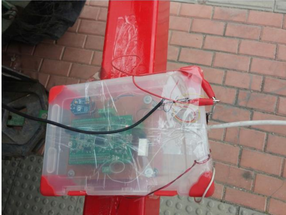
Ilustración 74. STM32f407 y XBee de transmisión de datos
