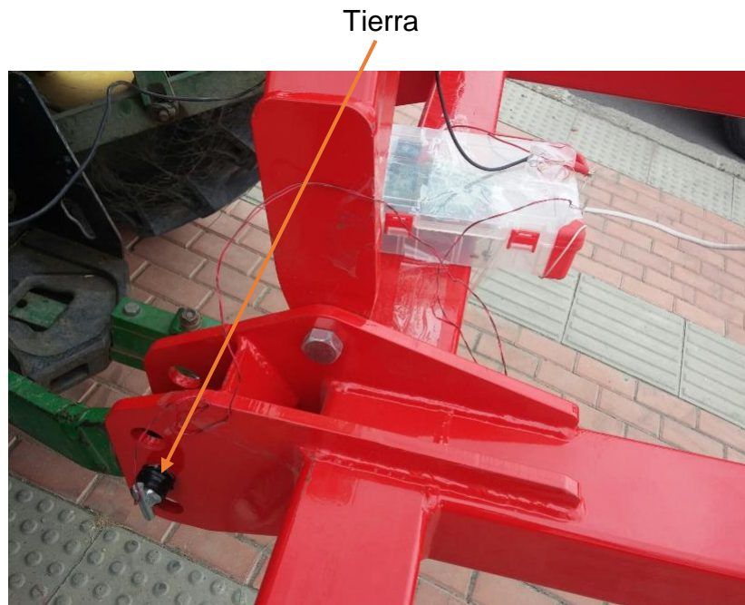
Ilustración 23. Alimentación circuito electrónico, tierra tomada de la masa de la herramienta.
