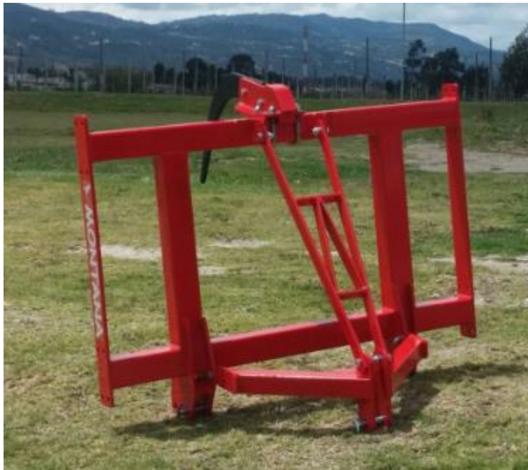
Ilustración 67. Estructura tubular, soporte y cincel.
