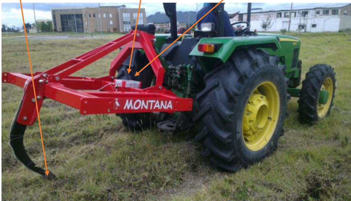
Ilustración 70. Tractor con arado tipo cincel y circuito eléctrico.
