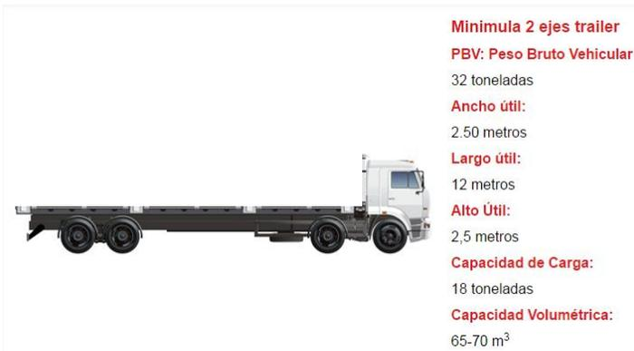
Ilustración 6 - Tipos de vehículos utilizados en el transporte de cemento: Fuente: Ditransa 2015, Nuestra oferta, tipos de vehículos
