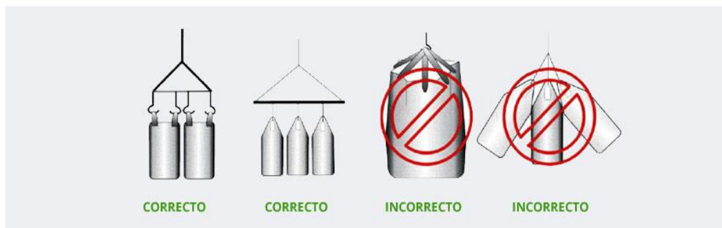
Grafico No. 8 Uso Correcto de Tenedor para Manipulación de Bolsones por 1500 KG.
