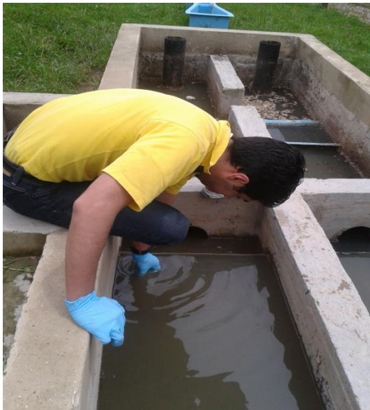
Figura 11. Toma de la muestra en la entrada a la ptar
