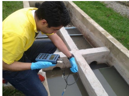
Figura 9. Realizando ensayo de medida de PH y temperatura en campo
