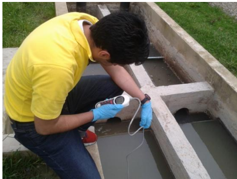
Figura 8. Realizando ensayo de conductividad en campo
