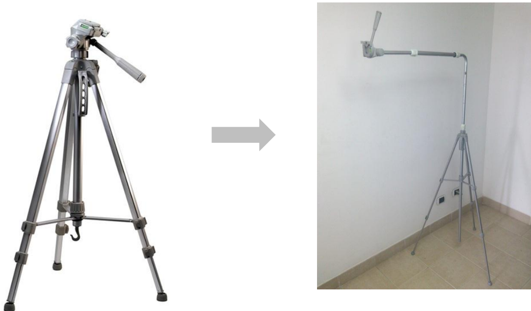
Figura 27. Modificación del trípode WEIFENG WT3520.
