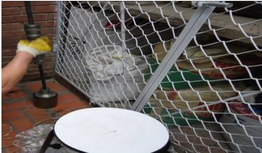
Foto No. 12 Desmolde de la briqueta. Fuente el autor.
