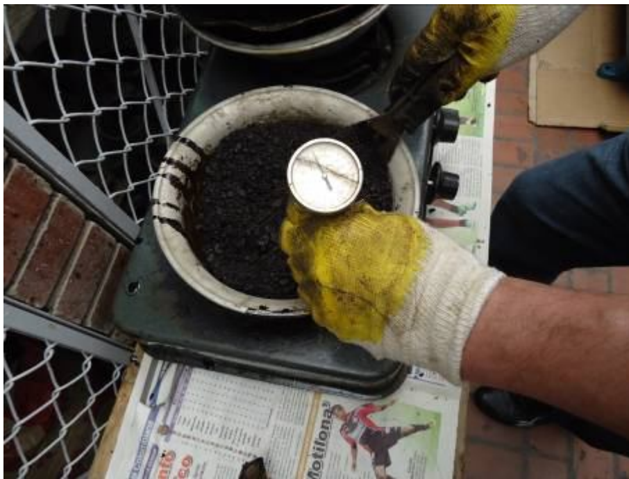
Foto No. 8 Toma temperatura de mezclado. Fuente el autor.
