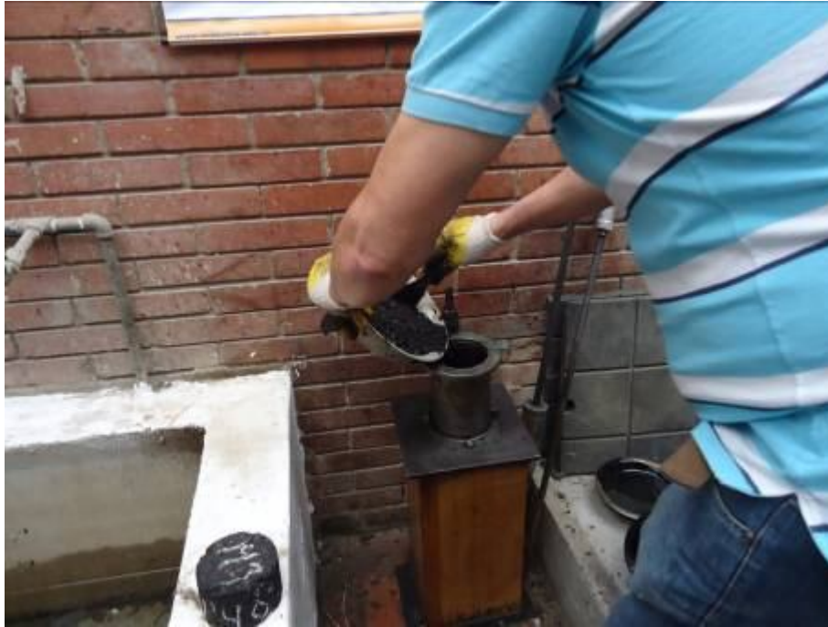
Foto No. 9 Elaboración briquetas. Fuente el autor.
