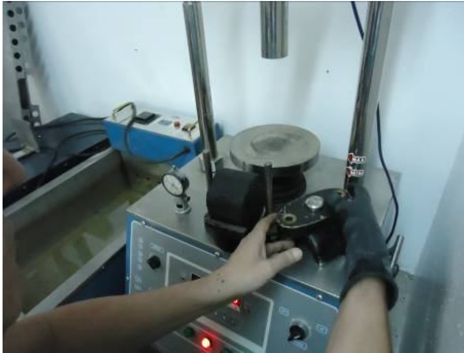
Foto No. 24 Preparación briqueta a fallar. Fuente el Autor.
