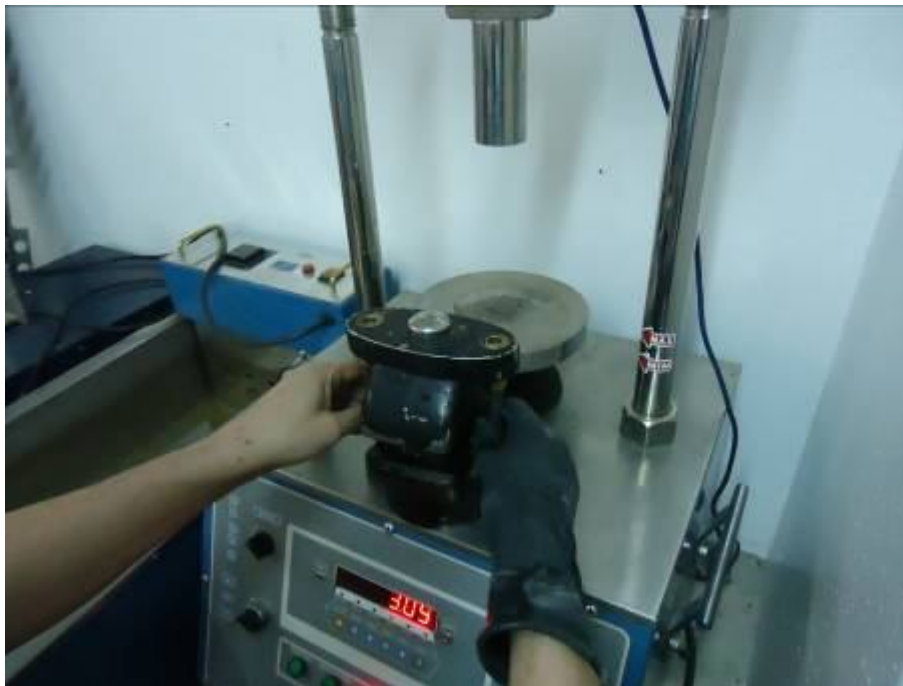
Foto No. 25 Alistamiento final de la briqueta a fallar. Fuente el autor.
