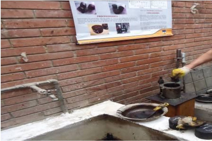
Foto No. 10 Extracción de vacíos de la briqueta. Fuente el Autor.
