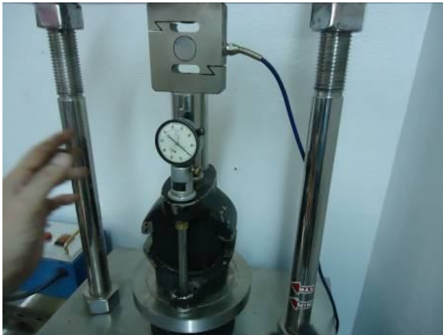
Foto No. 27 Inicio del proceso de falla de la briqueta. Fuente el autor.
