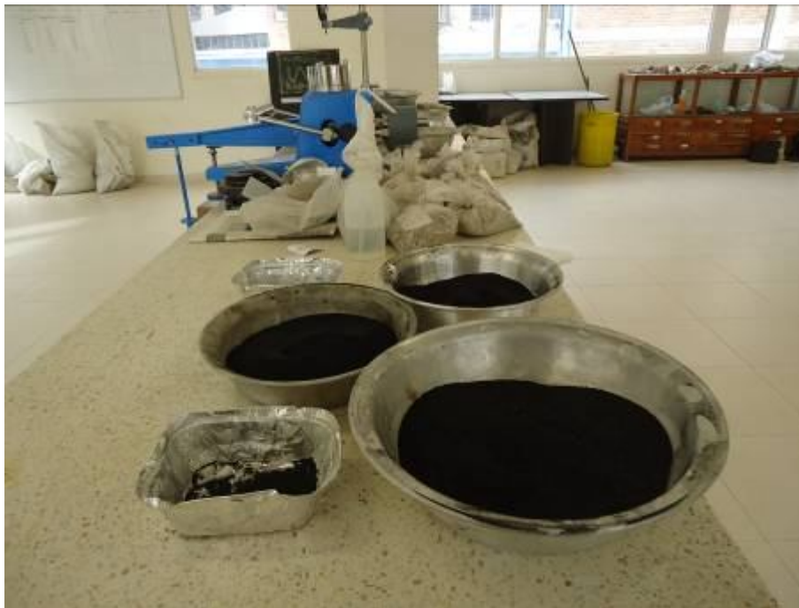
Foto No. 5 Asfalto 80.100. Fuente el autor.
