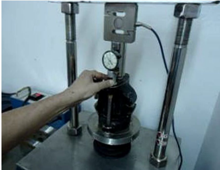
Foto No. 28 Etapa final del proceso de falla de la briqueta. Fuente el autor.
