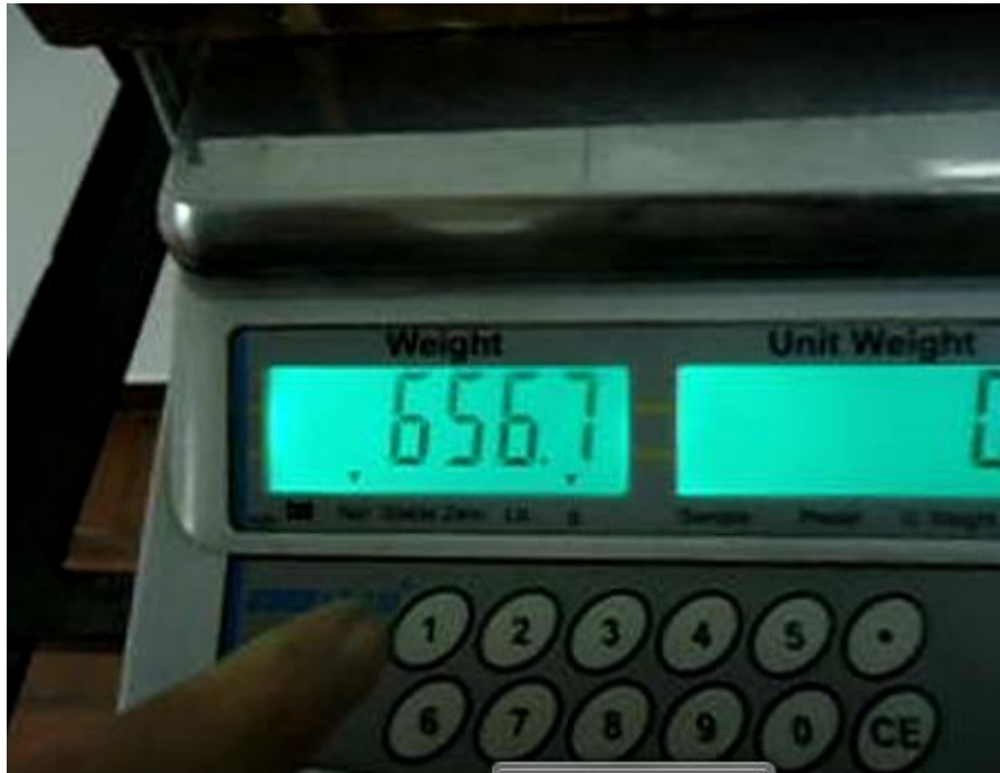
Foto No. 19 Peso de la briqueta en el agua. Fuente el autor.
