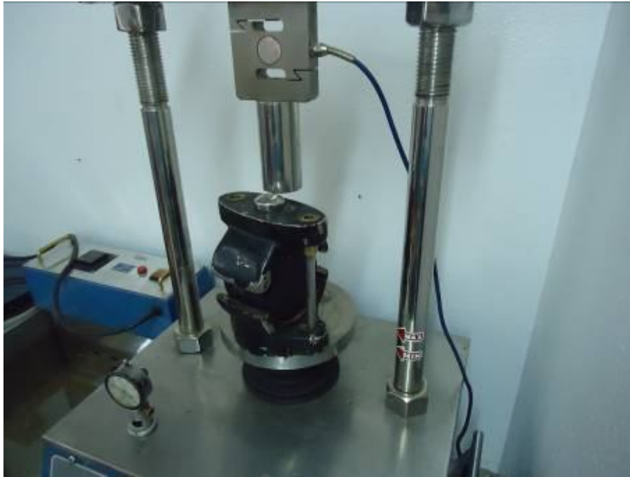
Foto No. 26 Briqueta colocada en el Aparato Marshall. Fuente el autor.
