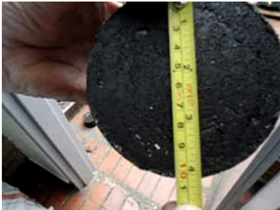
Foto No. 17 Cálculo volumen - Toma de diámetro briqueta. Fuente el autor
