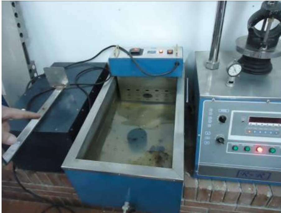
Foto No. 21 Briqueta en el tanque en baño de maría. Fuente el autor.
