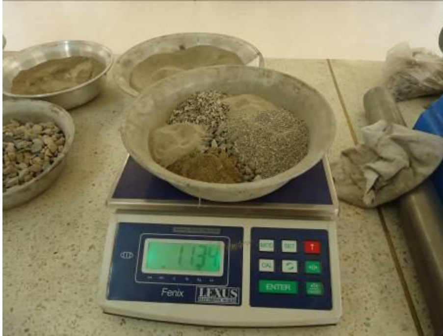
Foto No. 4 Dosificación agregados. Fuente el autor
