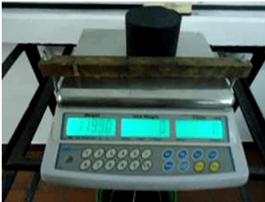
Foto No. 20 Peso de la briqueta del aire luego de sumergida. Fuente el autor.
