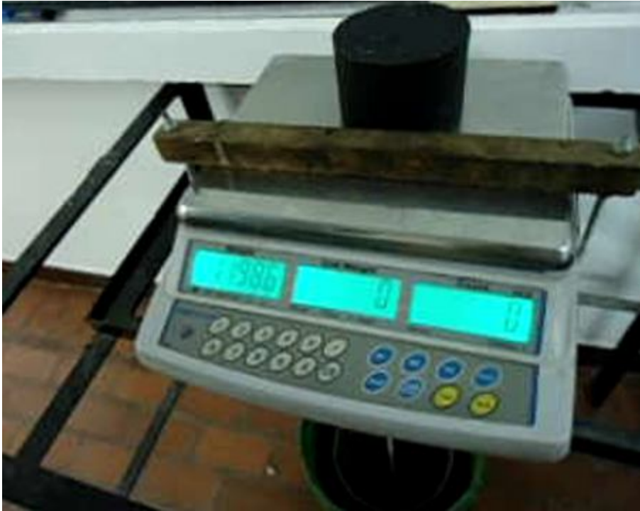
Foto No. 18 Peso de la briqueta en el aire. Fuente el autor.
