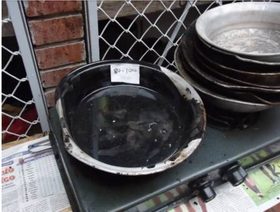
Foto No. 6 Asfalto 80-100. Fuente el autor
