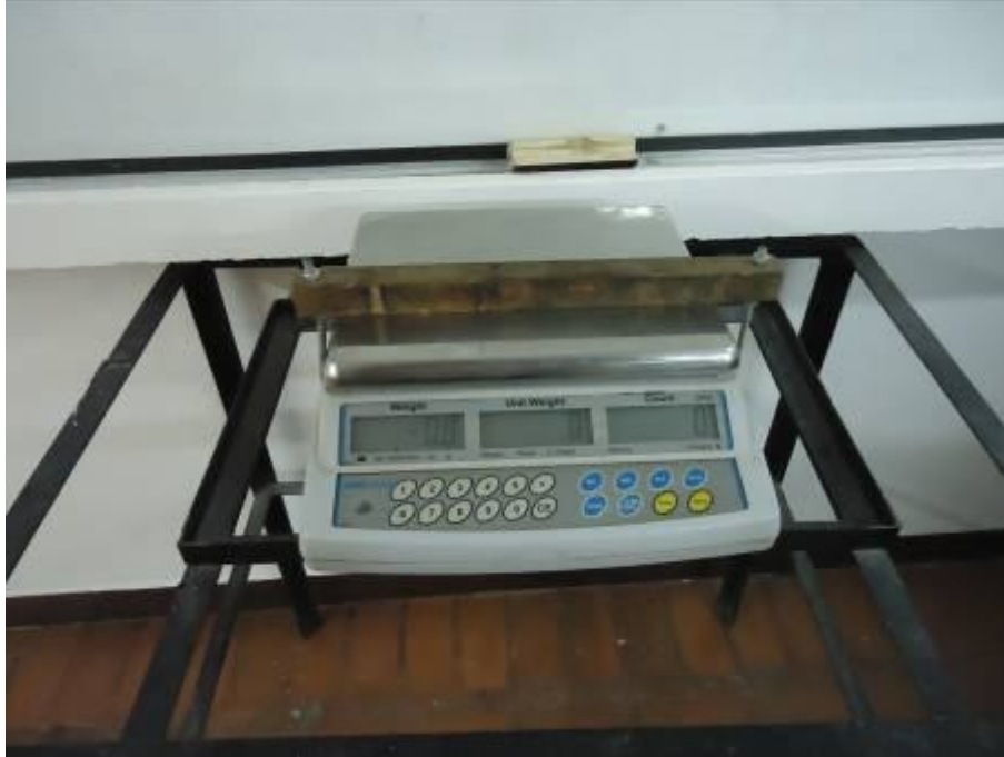
Foto No. 14 Preparación balanza para cálculo de densidades. Fuente el autor.
