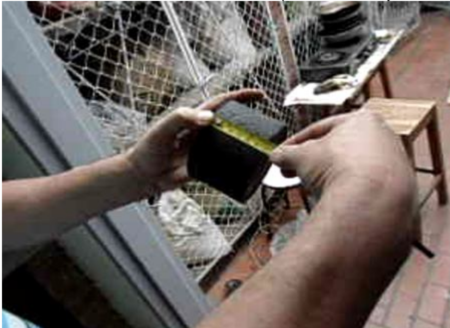
Foto No. 16 Cálculo volumen –Toma de altura- briqueta. Fuente el autor.
